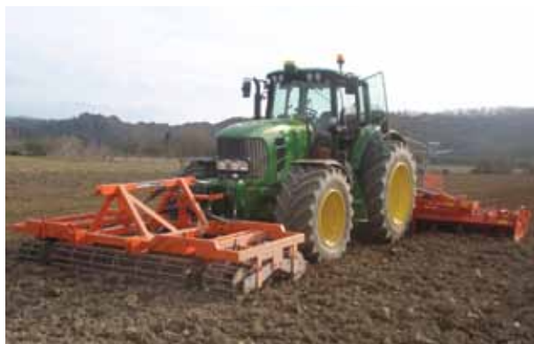
Tracteur avec combinaison herse rotative/semoir & tasse avant
